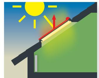
Os acessórios exteriores são a melhor proteção contra as altas temperaturas. Absorvem os raios UVA antes que estes cheguem ao vidro, evitando assim, o excesso de calor nos dias de verão
