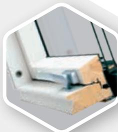
As janelas de madeira revestida de poliuretano são destinadas a divisões com alto nível de humidade (cozinhas, casas de banho). São tratadas a vácuo e revestidas de três camadas de espuma de poliuretano, que cria na superfície do aro uma camada branca, duradoura e perfeitamente lisa.
